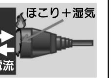
トランギング現象とは、コンセントと差し込みプラグの間に溜まったホコリが空気中の湿気を吸って電気を通しやすい状態になり、ショートし発火する現象です。
