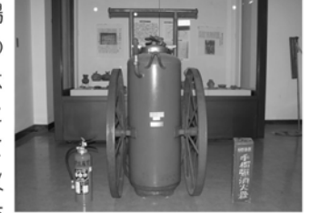
左から現在使われている消火器、大型消火器、手りゅう弾消火器
